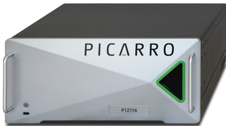
图2 Picarro PI2114 气体浓度分析仪提供了从 100 ppm 至 3.3 ppb 的 H_2O_2 持续监测，精度为 1.1 ppb
