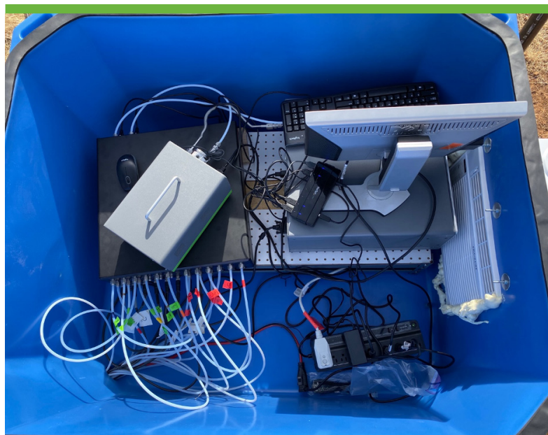
图 4. 装有 Picarro G2508 和 Eosense eosMX 的箱子内部。
