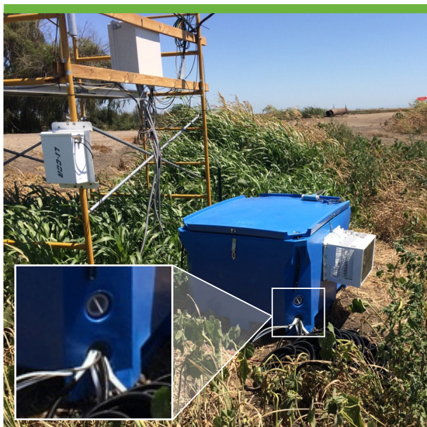
图 3. 现场部署经过改造的 Bonar 塑料渔具箱。
