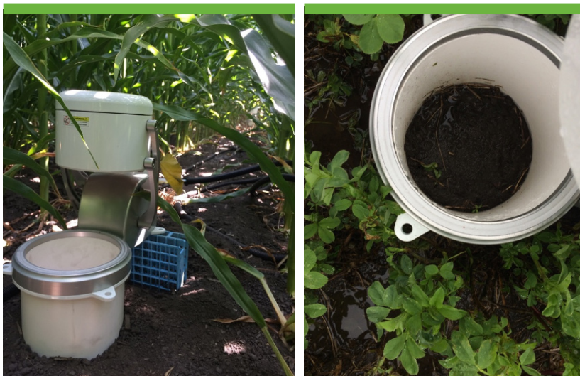
图 1. 现场部署的 eosAC 呼吸室，安装了经过改造的 15 厘米土壤环(左)，环内外土壤湿度相似(右)。
