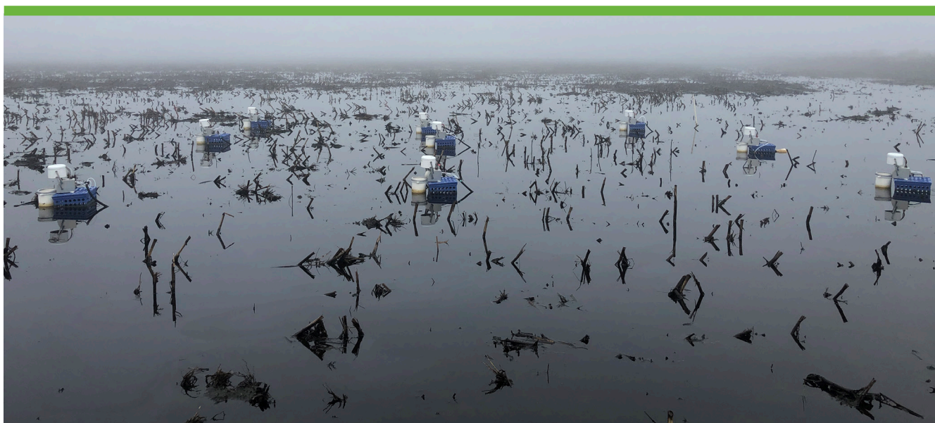
图 2. 休耕期淹水期间，安装有 30 厘米土壤环的呼吸室。
