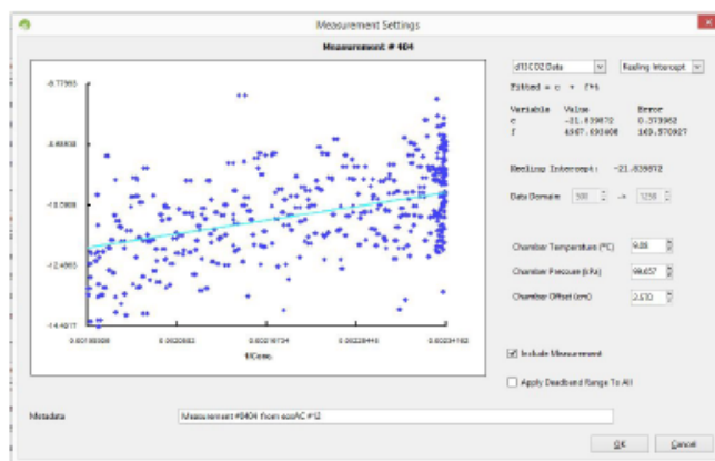
图 4. \text{CO}_2 同位素 Keeling 图显示土壤 \text{CO}_2 通量的估计 \delta^{13}\text{C} 同位素值为 -21.8\text{‰} 。
