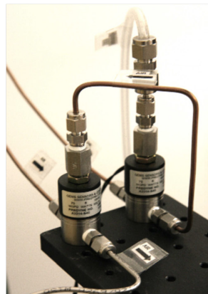
图中显示了 Picarro 分析仪和二级泵的典型运行方式，可从塔上的长管中快速吸入空气。
