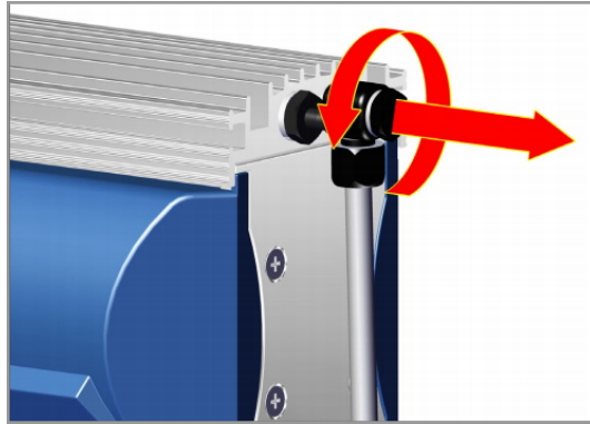
Figura 55 - Afloje la tuerca que sujeta la tapa de la carcasa
