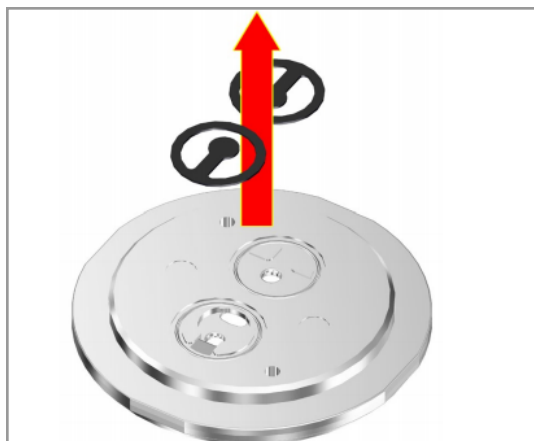
Figura 59 - Extracción de las válvulas de la tapa del cabezal
