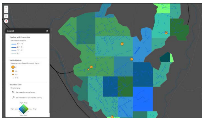
Figura 4. A imagem NAV mostrada representa um gráfico da densidade das emissões versus a densidade do vazamento com fontes pontuais de alta emissão e segmentos de tubulação sobrepostos. O NAV permite uma análise rápida de dados complexos para tomar decisões responsáveis em relação à infraestrutura de rede.
